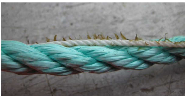
FIGUR 5. OPVIKLING AF 2 MM SPIRELINE PÅ 8 MM REB INDEN UDSÆTNING I ÅBENT VAND.
