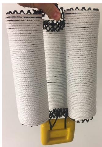
FIGUR 12. TO TYPER SUBSTRAT KLAR TIL SÅNING I BOBLETANKE. FORSKELLIGE TYPER AF VÆGTE PÅHÆFTES FOR AT UNDGÅ AT SUBSTRATERNE FLYDER.
