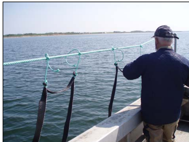
Figur 1. Eksempel på enkelthængende yngelopsamlere (til venstre) og kontinuerlige opsamlere (til højre)
