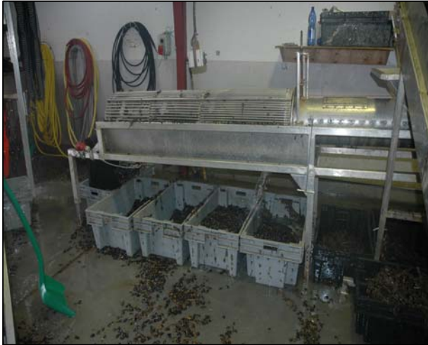
Figur 3. Sortering og strømpning af yngel. I den hvide kasse for enden findes de færdige strømper klar til udhæng.
