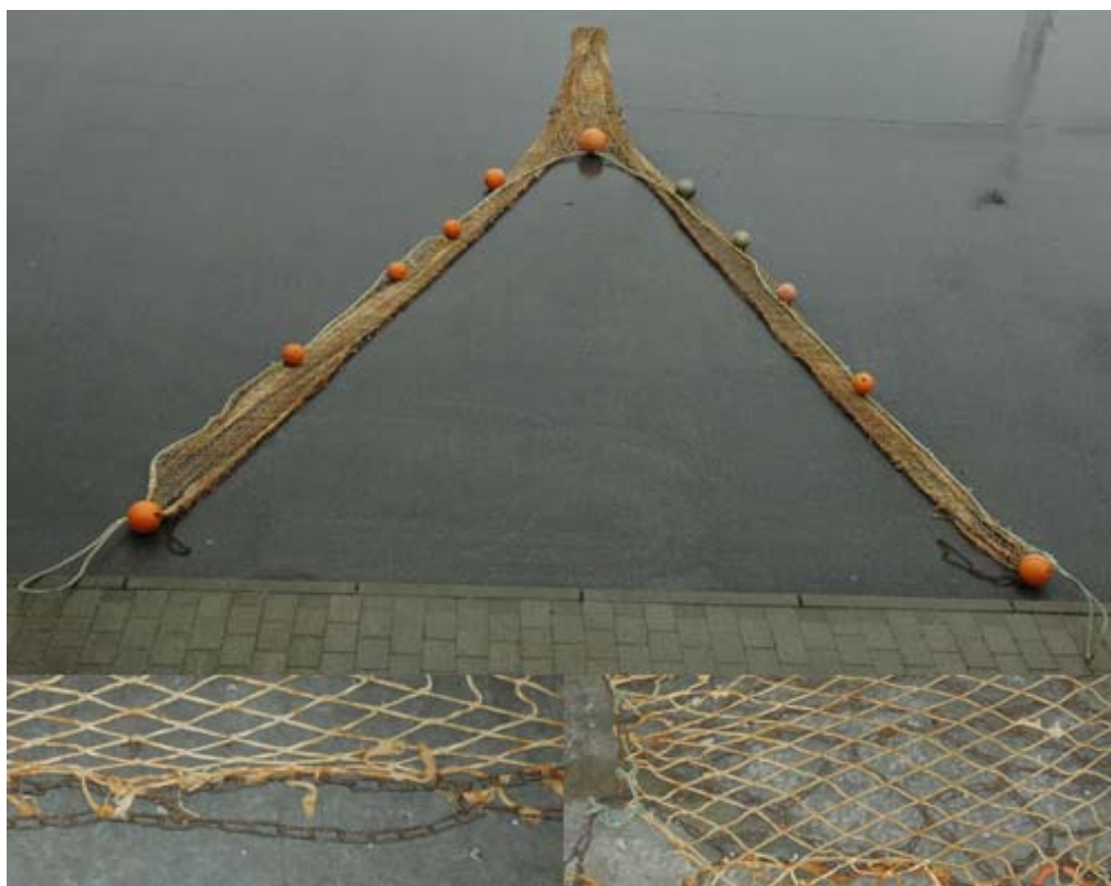
Figur 6.7: Netpose fra det gamle danske søstjernevod, som lå til grund for videreudviklingen til det moderne søstjernevod. Nederst i billedet ses til venstre et nærbillede af undertællen og til højre et nærbillede af redskabets bund med kædenet på undersiden.
