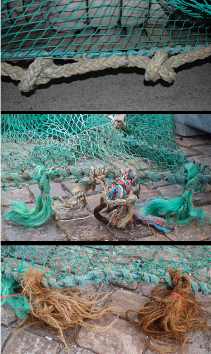
Figur 8.11: Afstandsgivere på undertælle af søstjernevod. Øverst: faste afstandsgivere i form af knuder på kraftig undertælle. Midterst: Faste afstandsgivere i form af tovværkskvaste og justerbar afstandsgiver i form af metaldele ophængt i tovværk. Nederst: Faste afstandsgivere i form af tovværkskvaste.
