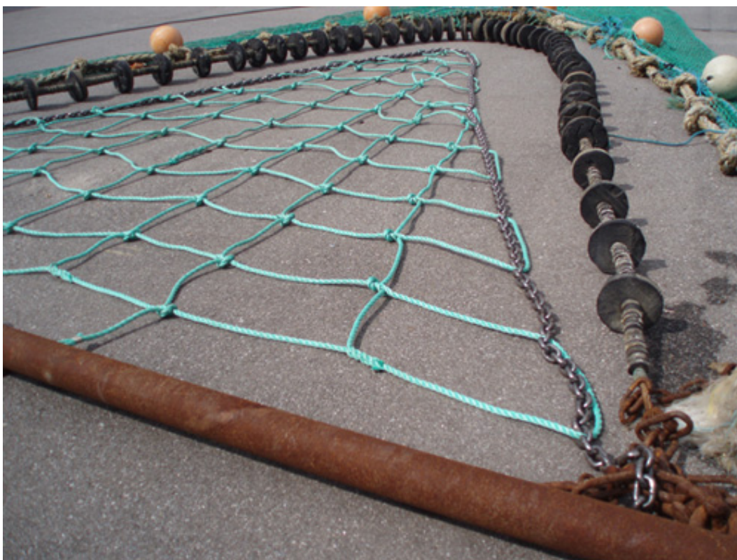
Figur 9.2: Nærbillede af søstjernevod, hvor de to gravekæder er erstattet af en nyudviklet netanordning. Nettet er bundet af 10 mm blytov og har en maskevidde på ca. 200 mm halvmaske. Kæden, som udgør nettets bagkant, er placeret samme sted, som den ene af gravekæderne tidligere fandtes.
