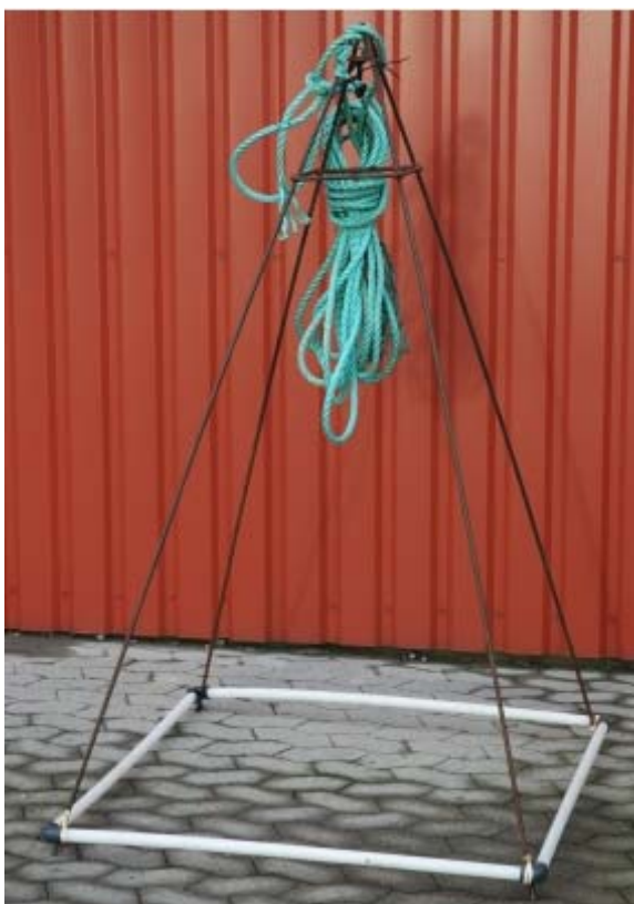
Figur 10.10: Billede af prøvetagningsudstyret. Kameraet er ikke monteret på billedet, men sad monteret i toppen af stativet på et bevægeligt kugleled
