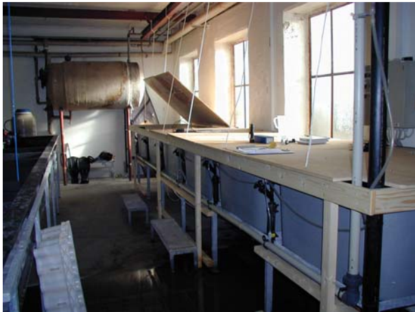
Figur 4.1. Moderøstersanlægget. I den enkelte tank er placeret en netpose som opsamler de frigivne larver fra det pågældende kar.
