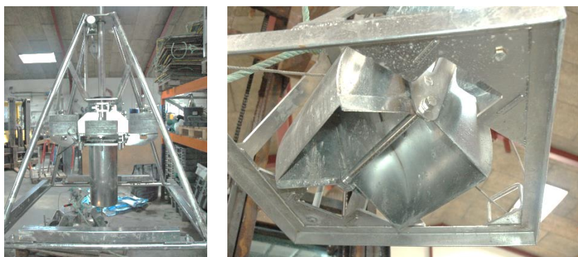
Figur 1. Billeder til venstre: Haps der blev brugt til prøvetagning. Billede til højre: Grab der blev brugt til prøvetagningen.
