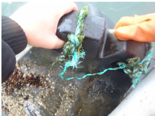
Figur 3 Bøjetov der er slidt over
