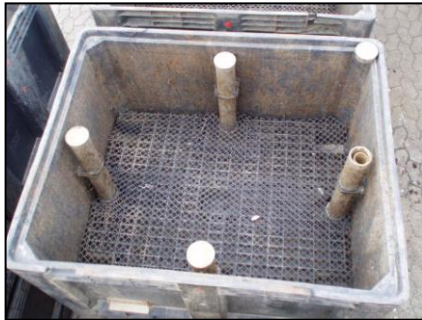
Figur 9. "Gammel LiCo-tank" Fra en ovenstående tank ledes vand ind i toppen af tanken (1).Vandet passerer herefter ned imellem muslingerne og føres ud i bunden af 4 sidestillede dobbelte stigerør. Dobbelttrørene muliggør et vandudtag ved bunden af tanken via et hul i det yderste af de to rør (2). Vandet stiger således op i mellem de to rørføringer og ud i top (3). Herfra ledes det ned i næste tank via det inderste rør (4). De forventede "døde iltfattige områder" er angivet på figuren ved røde cirkler.
