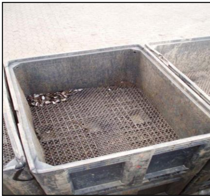
Figur 10. "Ny LiCo-tank". Vand ledes ind i toppen af tanken fra ovenstående tank (1) og føres ud af tanken via 4 hjørnehuller i top (2). En gennemføring på 2 cm i bunden af tanken (under dobbeltbunden) virker som ekstra dræn (3). De forventede "døde iltfattige områder" er angivet på figuren ved røde cirkler.
