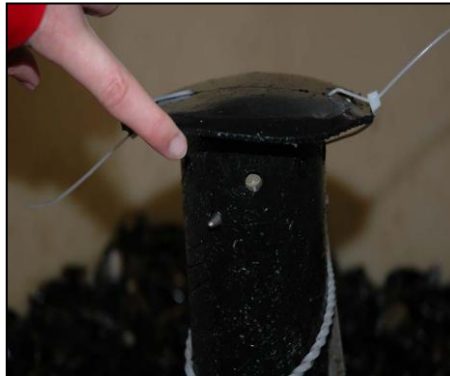
Figur 11. "Shetlandstank" Vand ledes fra ovenstående tank ind i toppen af tanken (1), og passerer ned imellem de opbevarede muslinger. Herefter føres det ud i bunden via midtstillet dobbelt stigerør (2). Vandet stiger op i hulrummet mellem det to rør og ledes ud i toppen af det inderste rør (3). Derfra ledes det ned i næste tank via gennemføring i bund (4). De forventede "døde iltfattige områder" omkring det midterstillede dobbelt rør er angivet på figuren ved røde cirkler.
