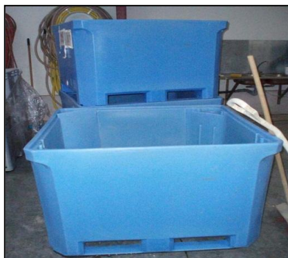
Figur 12. "Blå tank" Fra en ovenstående tank føres vand ind i toppen af tanken (1). Herefter passer vandet ned igennem muslingerne, og ledes ud i bunden ved 2 af de 4 hjørner (2). For at sikre at vandudtaget sker fra bunden er afgangshullerne i de 2 hjørner adskilt fra resten af tanken med en skråtstillet plade, der kun er åben ved tankens bund. Vandet stiger således op i de 2 hjørner bag den skrå pladen (3) og ledes ned i næste tank via et gennemgående hul (3). De forventede "døde iltfattige områder" omkring de to hjørner modsat vandflowet er angivet på figuren ved røde cirkler.
