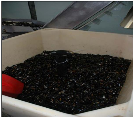
Figur 11. "Shetlandstank" Vand ledes fra ovenstående tank ind i toppen af tanken (1), og passerer ned imellem de opbevarede muslinger. Herefter føres det ud i bunden via midtstillet dobbelt stigerør (2). Vandet stiger op i hulrummet mellem det to rør og ledes ud i toppen af det inderste rør (3). Derfra ledes det ned i næste tank via gennemføring i bund (4). De forventede "døde iltfattige områder" omkring det midterstillede dobbelt rør er angivet på figuren ved røde cirkler.
