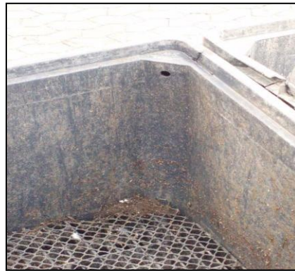
Figur 10. "Ny LiCo-tank". Vand ledes ind i toppen af tanken fra ovenstående tank (1) og føres ud af tanken via 4 hjørnehuller i top (2). En gennemføring på 2 cm i bunden af tanken (under dobbeltbunden) virker som ekstra dræn (3). De forventede "døde iltfattige områder" er angivet på figuren ved røde cirkler.
