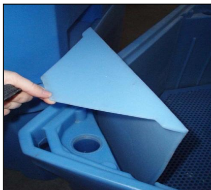
Figur 12. "Blå tank" Fra en ovenstående tank føres vand ind i toppen af tanken (1). Herefter passer vandet ned igennem muslingerne, og ledes ud i bunden ved 2 af de 4 hjørner (2). For at sikre at vandudtaget sker fra bunden er afgangshullerne i de 2 hjørner adskilt fra resten af tanken med en skråtstillet plade, der kun er åben ved tankens bund. Vandet stiger således op i de 2 hjørner bag den skrå pladen (3) og ledes ned i næste tank via et gennemgående hul (3). De forventede "døde iltfattige områder" omkring de to hjørner modsat vandflowet er angivet på figuren ved røde cirkler.
