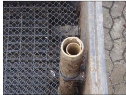
Figur 9. "Gammel LiCo-tank" Fra en ovenstående tank ledes vand ind i toppen af tanken (1).Vandet passerer herefter ned imellem muslingerne og føres ud i bunden af 4 sidestillede dobbelte stigerør. Dobbelttrørene muliggør et vandudtag ved bunden af tanken via et hul i det yderste af de to rør (2). Vandet stiger således op i mellem de to rørføringer og ud i top (3). Herfra ledes det ned i næste tank via det inderste rør (4). De forventede "døde iltfattige områder" er angivet på figuren ved røde cirkler.
