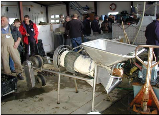
Figur A3. Strømpemaskine fra Talleres Aguin til fremstilling af kontinuerte strømper (Ejes af Sydfyns Linemusling ApS.).
