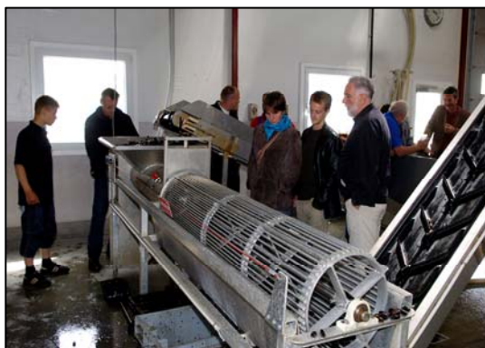
Figur A5. Den canadiske sorteringsmaskine med sortertromle i forgrunden og indlæsningstragt i baggrunden.
