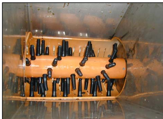
Figur A8. Indvendigt rør med gummifingre til fremføring af muslinger. I bunden kan man se sorterslidser i 6 mm.
