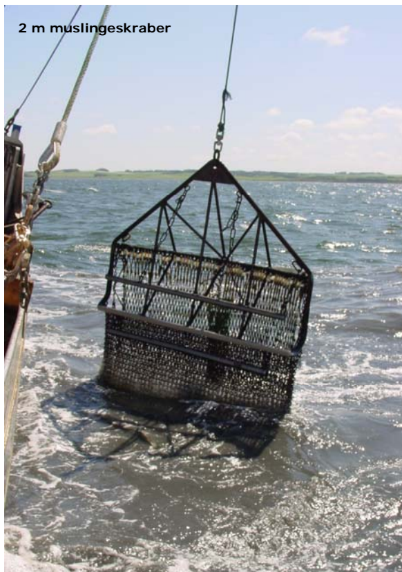
Figur 1A- B. Henholdsvis en 2 meter muslingeskraber og en østersskraber
