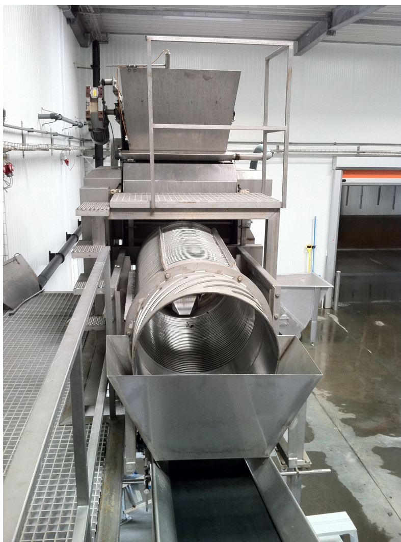
Figur 2. Sorteringstromle installeret på Vilsund Blue a/s i forbindelse med forsøg.
