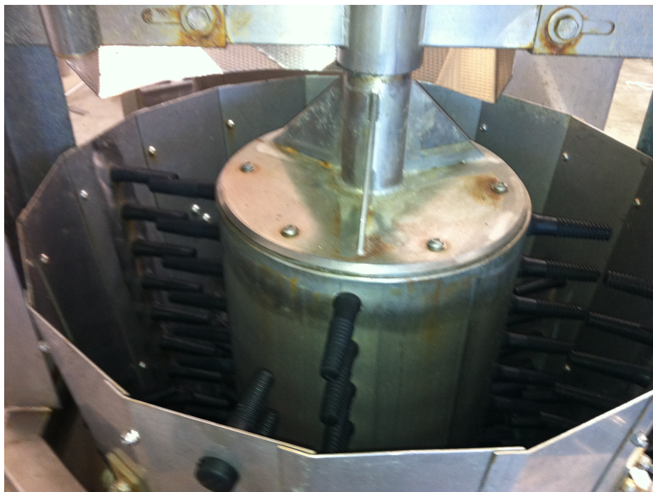
Figur 1. Declumper installeret på Vilsund Blue a/s i forbindelse med forsøg.
