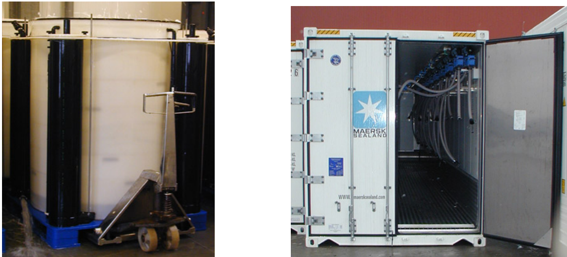
Figur 4. aQalifsystemet er opbygget omkring en transportenhed (billede til venstre) hvoraf der kan anbringes 20 transportenheder i en specialindrettet kølecontainer (billede til højre).
