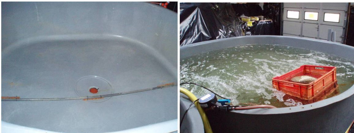
Figur 23. Den store vandtank med perforeret rør i bunden af karret. På billedet til højre ses karret i brug, med tydelig omrøring af vandet.
