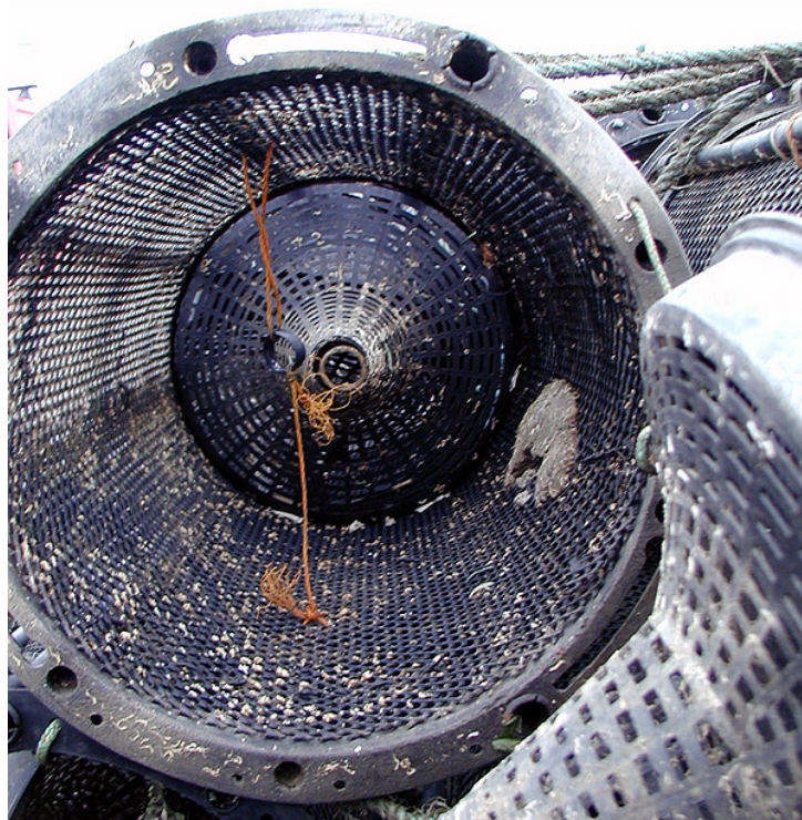
Figur 4.3: Snoreanordning til fastholdelse af agnfisken inde i tejnens. Den sorte gummiring i midten af tejnens, som de to snorehalvdele er fastgjort i, er fremstillet af et stykke cykelslange. Bemærk at denne tejne er forsynet med en klat cement for at give tejnens ekstra vægt. Cementklatten ses til højre for billedets midte.
