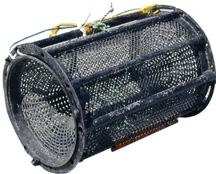
Figur 4.2: Den irske plasttejne til fangst af rejer. Den afbildede tejne er forsynet med en uoriginal fjederstrop til ekstra sikring af endestykkerne, uoriginal bundvægt af 14 mm tentorstål samt en 6 mm line til fastgørelse af tejnen.
