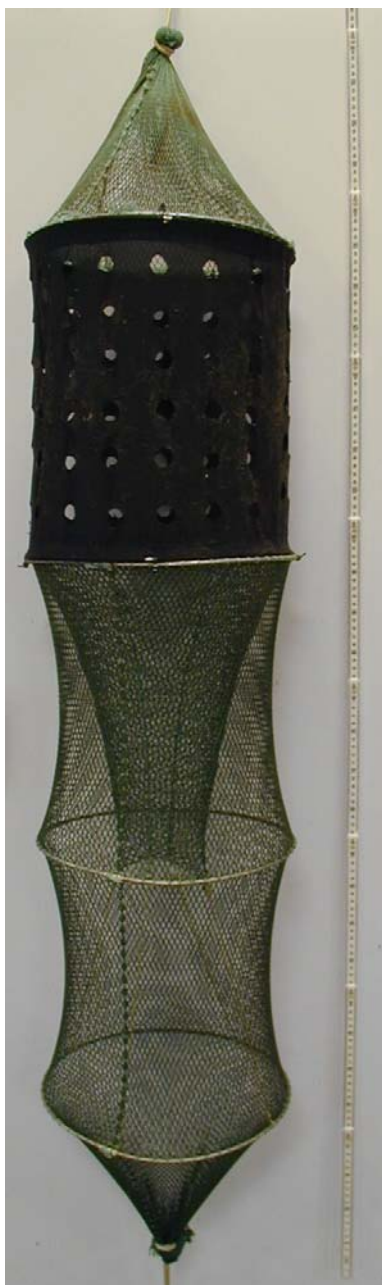
Figur 4.16: DSC-ruse , prototype 3. Monteret på rustfri ståløjler Ø 30 cm, maskestørrelse 8 mm halvmaske. Hele redskabets længde ca. 1,60 meter. For størrelsesforhold, bemærk tommestok til højre i billedet.
