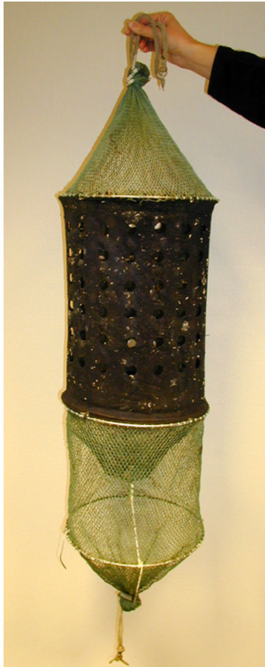
Figur 4.17: DSC-ruse, prototype 4. Bøjler Ø 30 cm, redskabets samlede længde var 1,0 m.
