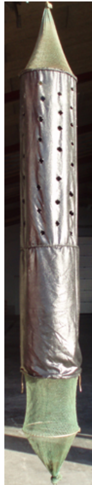
Figur 4.15: DSC-ruse , prototype 2. Monteret på rustfri stålbojler Ø 30 cm, maskestørrelse Ø 8 mm halvmaske. Hele redskabets længde ca. 2,60 meter.
