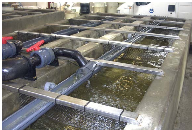
Figur 7.2 Fordelt på to lange kar, blev knivmuslingerne etableret i 10 enheder med et areal på 1,0 \times 0,5 m. Mellem enhederne, der var markeret med net, var der fri vandudveksling. Vandet blev fordelt i hele karret vha. en tagrende med huller.
