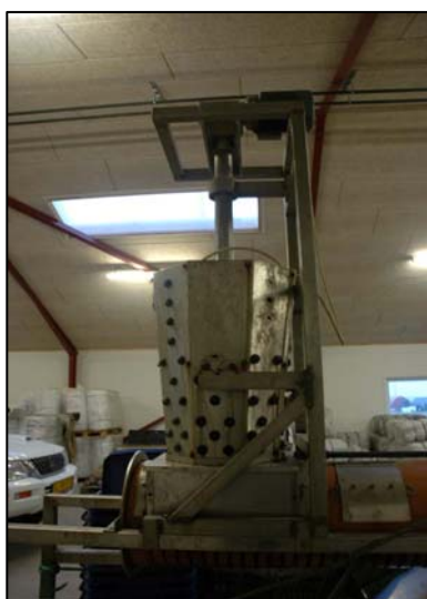
Figur 5.34. Horisontalt stillede declumper på kloakrøret
