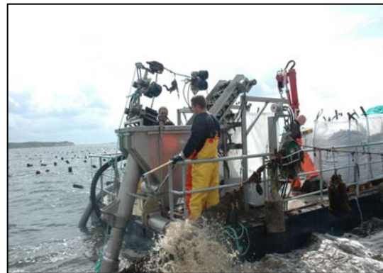
Figur 5.8. Illustration af hvorledes hovedlinen kører op over hauleren.
