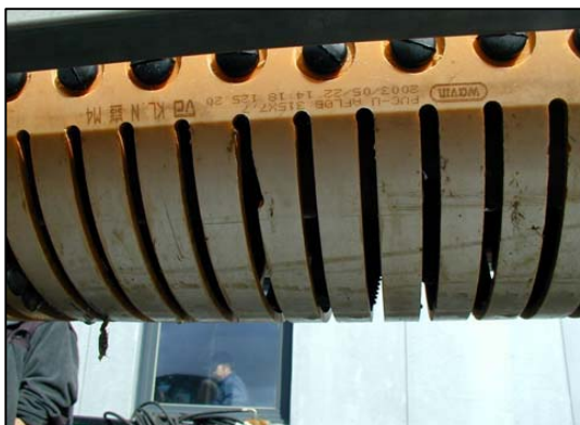
Figur 5.32. Opskårne slidser der går halvt gennem kloakrøret.
