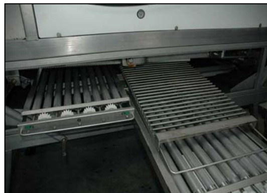
Figur 5.20. Viser de underliggende rammer; her vises både de roterende valser samt sorterristen.
